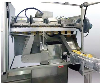
LA TECNOLOGIA SVILUPPATA DA ACMAVOLPAK PERMETTE DI CONFEZIONARE UN SINGOLO STICK ALL'INTERNO DI UN POUCH IN POSIZIONE VERTICALE, GARANTENDO ALLO STESSO TEMPO ACCESSIBILITÀ E FRAGRANZA DEL PRODOTTO.
